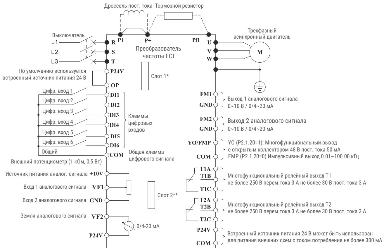
Стандартная конфигурация для преобразователей частоты мощностью от 18,5 кВт (по режиму G)
