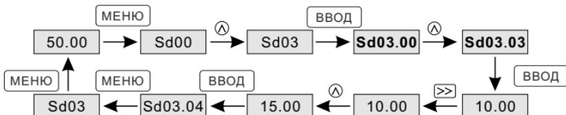
Рисунок 4-3. Пример изменения значения параметра
