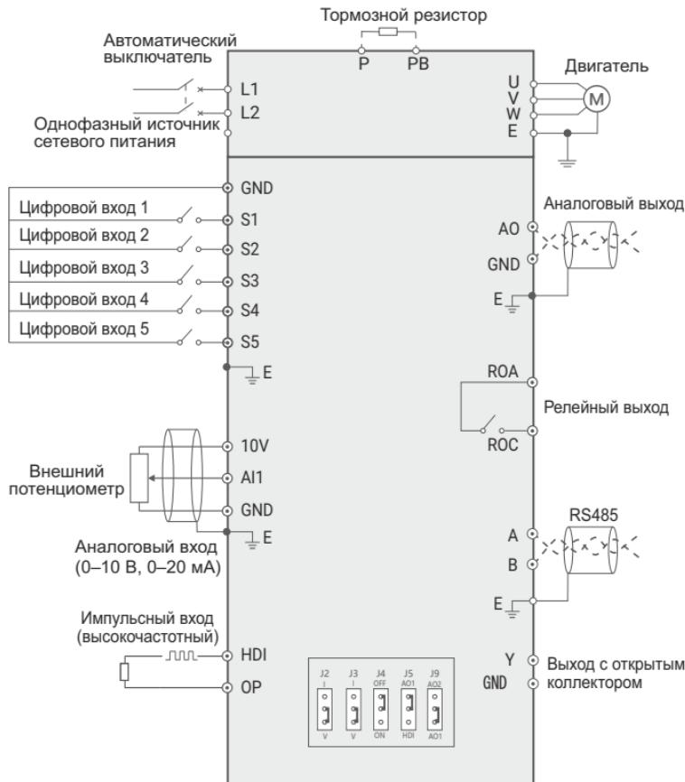
Рисунок 3-4. Схема основных электрических соединений (2)
