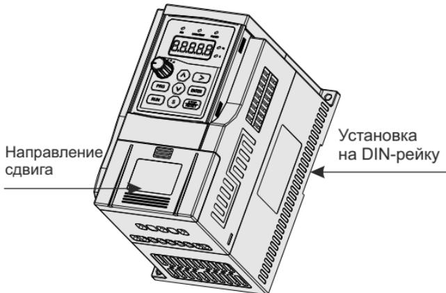
Рисунок 3-2. Демонтаж нижней пластмассовой крышки
