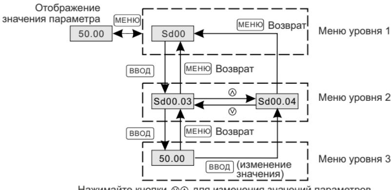
Рисунок 4-2. Порядок работы с панелью управления
