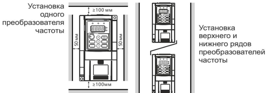
Рисунок 3-1. Схема установки
