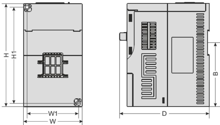
Рисунок 2-4. Габариты и монтажные размеры
