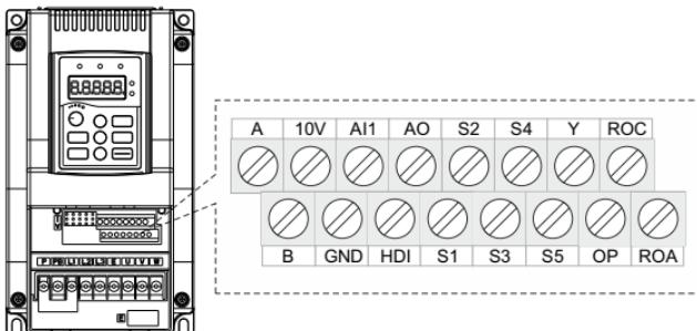
Рисунок 3-6. Схема расположения клемм цепей
