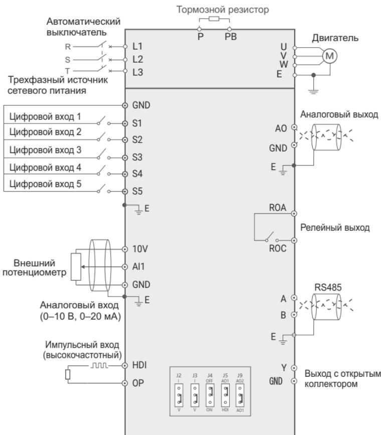
Рисунок 3-3. Схема основных электрических соединений (1)
