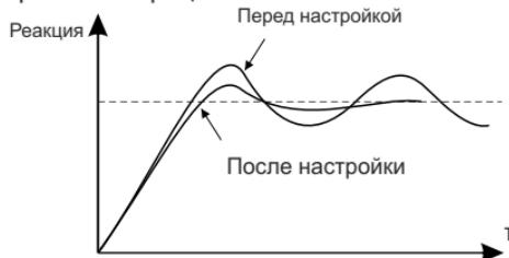
Контроль вибрации повышенной частоты: одинаковое время периода вибрации и установленного времени дифференцирования ( $T_d$ ) говорит о слишком сильном влиянии времени дифференцирования. Подавить такую вибрацию можно путем сокращения времени дифференцирования. Если при установке времени дифференцирования в 0.00 (отсутствует дифференциальное регулирование) вибрации не подавляются, уменьшите усиление.
