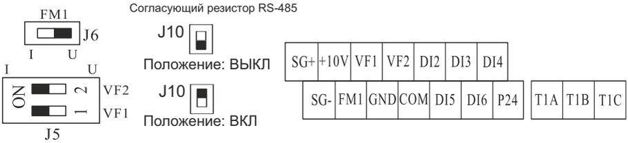
Стандартная конфигурация для преобразователей частоты серии MCI мощностью до 22 кВт
