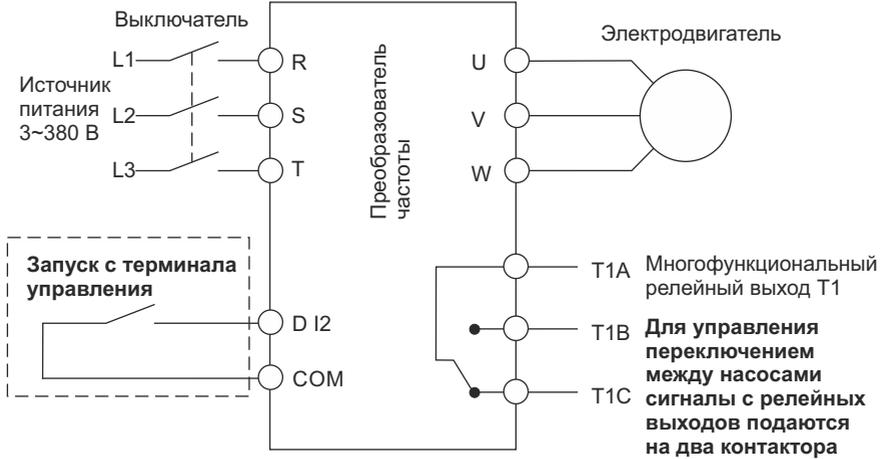
Схема коммутации преобразователя частоты в режиме поочередного управления двумя насосами для серии MCI
