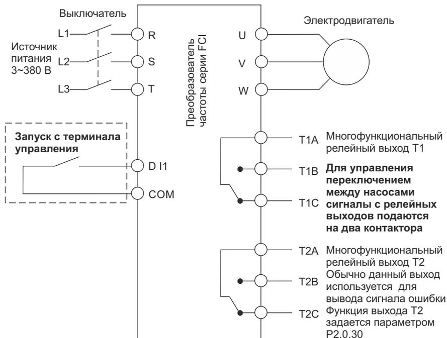
Схема коммутации преобразователя частоты в режиме поочередного управления двумя насосами
