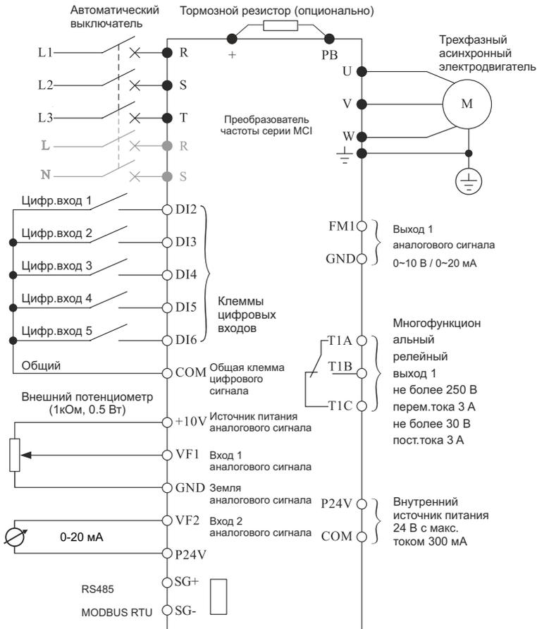
— обозначено однофазное подключение для моделей: MCI-G0.4-2B, MCI-G0.75-2B, MCI-G1.5-2B, MCI-G2.2-2B напряжение питания подается на R, S
