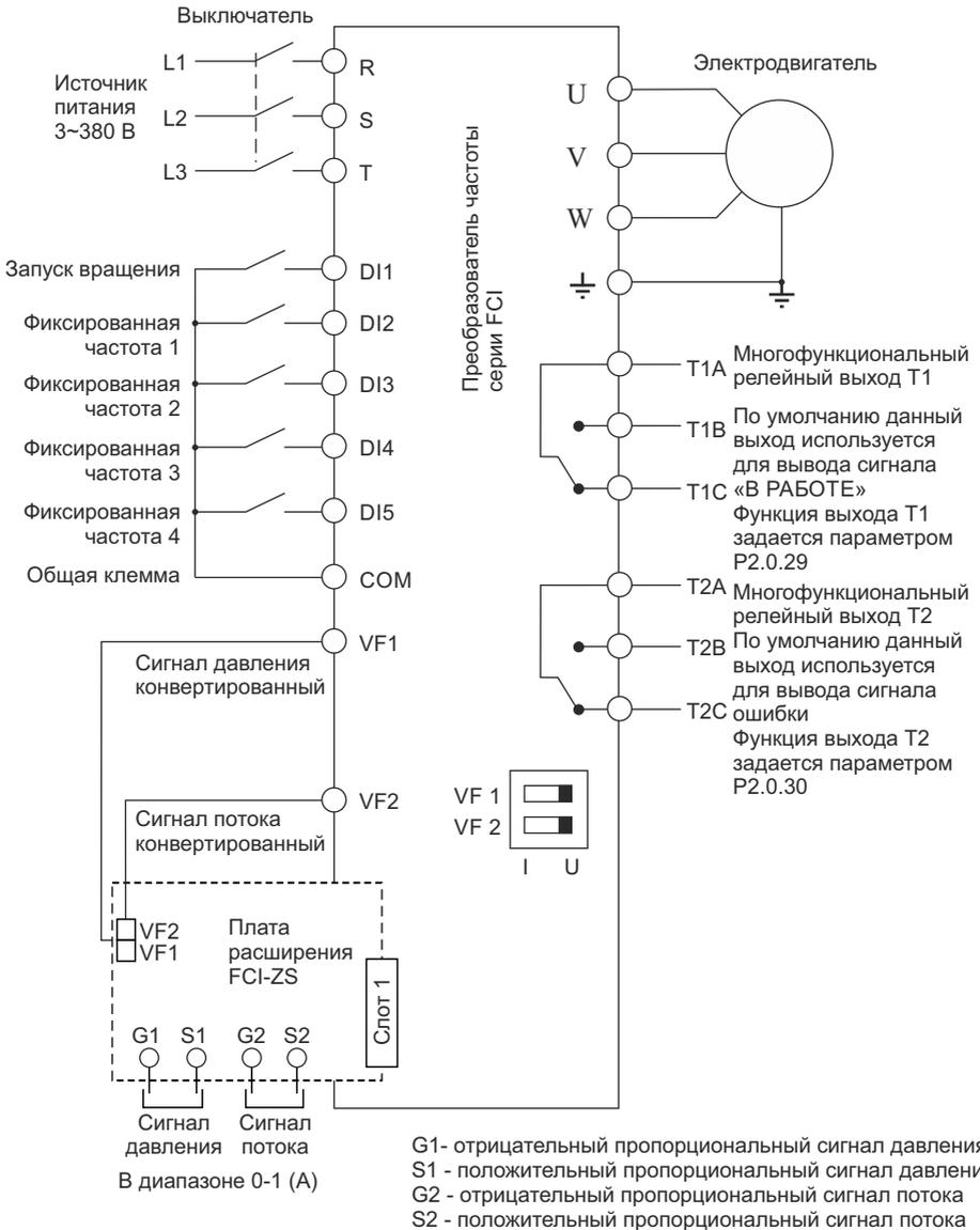
Значения функциональных кодов в режиме инжекционно-литьевой машины при подключении преобразователя частоты для серии FCI (при выборе режима инжекционно-литьевой машины установите значение функционального кода P5.0.19 равным 103)
