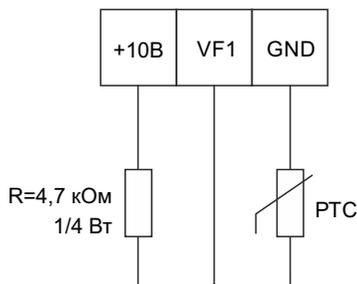
Режим работы: при снижении напряжения на входе с датчика менее 0.04В считается короткое замыкание датчика РТС, преобразователь частоты останавливается и высвечивается авария "Err21", при увеличении напряжения на входе с датчика РТС более 4,00В означает перегрев двигателя, преобразователь частоты останавливается и высвечивается авария "Err21".
